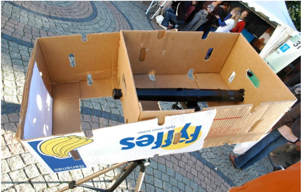
Her vises en kreativ løsning med Galileoskopet montert i banankasser. Da har man noe å feste det hvite arket på, det skygges for direkte sollys, og det blir nesten umulig å komme i skade for å kikke på sola gjennom Galileoskopet. Foto: Håkon Dahle, Oslo.
